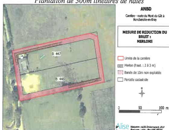
Création de merlons anti-bruit en phase d'exploitation
